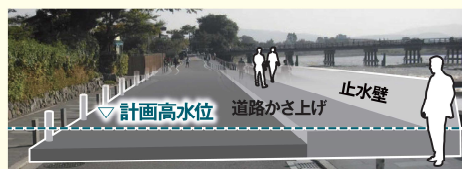
計画高水位までの道路かさ上げ+固定式止水壁イメージ
