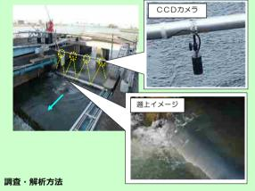
①最上流の魚道フラップ部に4台のCCDカメラを設置 ②5時から19時まで連続録画し、コンピューターによる自動画像解析 ③アユ以外の魚類(オイカワ等)が含まれる割合(例年実績で左右岸ともに5%)や短時間で多くのアユが遡上した場合の誤差率を用い、速報値を補正
