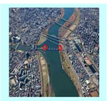
淀川大堰は淀川の河口から約10kmに位置し、塩水の遡上を防止し、淀川での安定した取水と大阪市内河川へ淀川の水を分流するのに役立っています。その淀川大堰の左右岸には、上流側の水位に追従して階段状の隔壁が可動する魚の通り道(魚道)が設置され、毎年春になるとアユの遡上が見られます。
