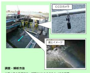
①最上流の魚道フラップ部に4台のCCDカメラを設置 ②5時から19時まで連続録画し、コンピューターによる自動画像解析 ③アユ以外の魚類(オイカワ等)が含まれる割合(例年実績で左右岸と もに5%)や短時間で多くのアユが遡上した場合の誤差率を補正
