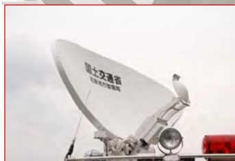
衛星通信用カセレンアンテナ (折りたたみ式)
