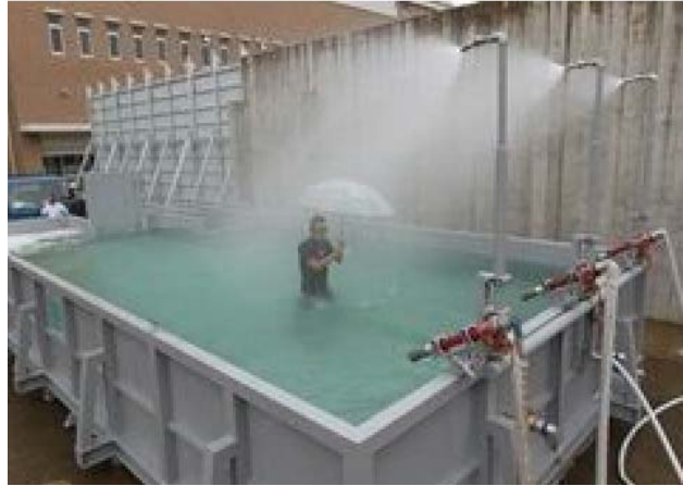
移動可能な地上設置型水槽
