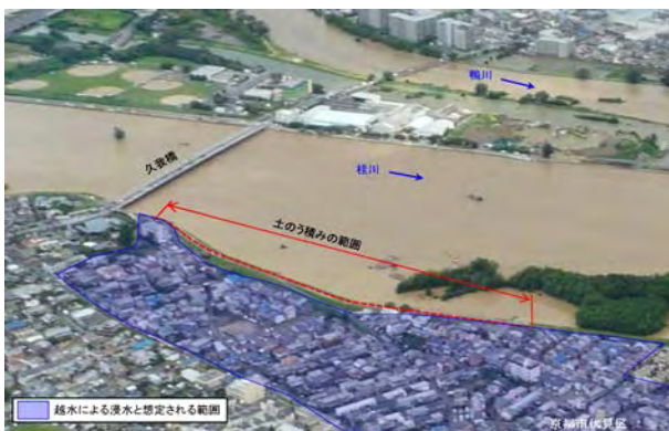
浸水範囲と土のう積みの範囲
