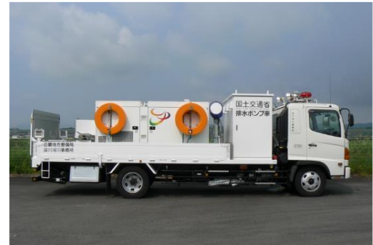
排水ポンプ車
