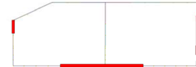
大型車通過台数100台時の剥離分布図
