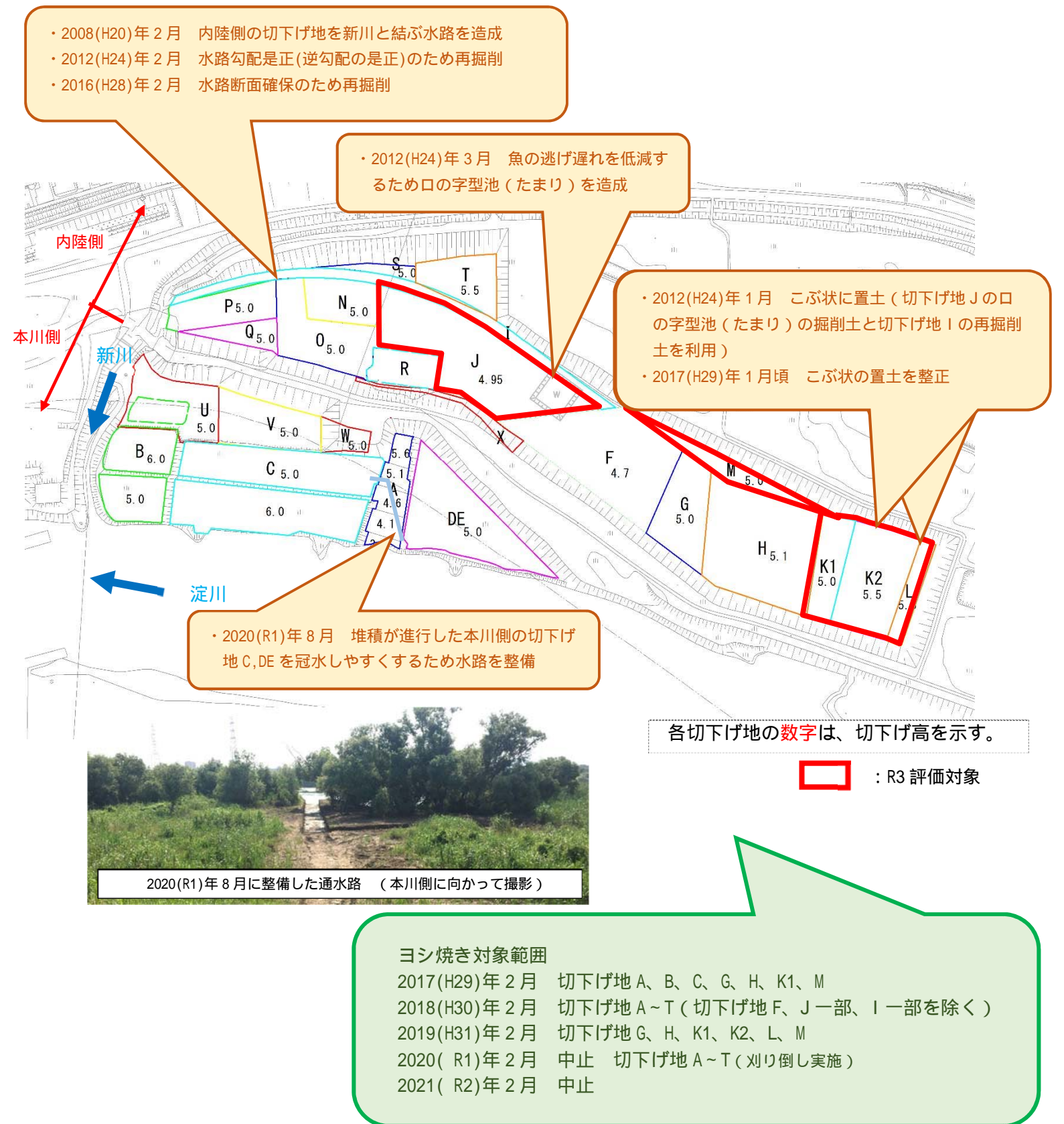
図3 切下げ地位置・切下げ地整備高さ・切下げ地整備後の維持的措置
