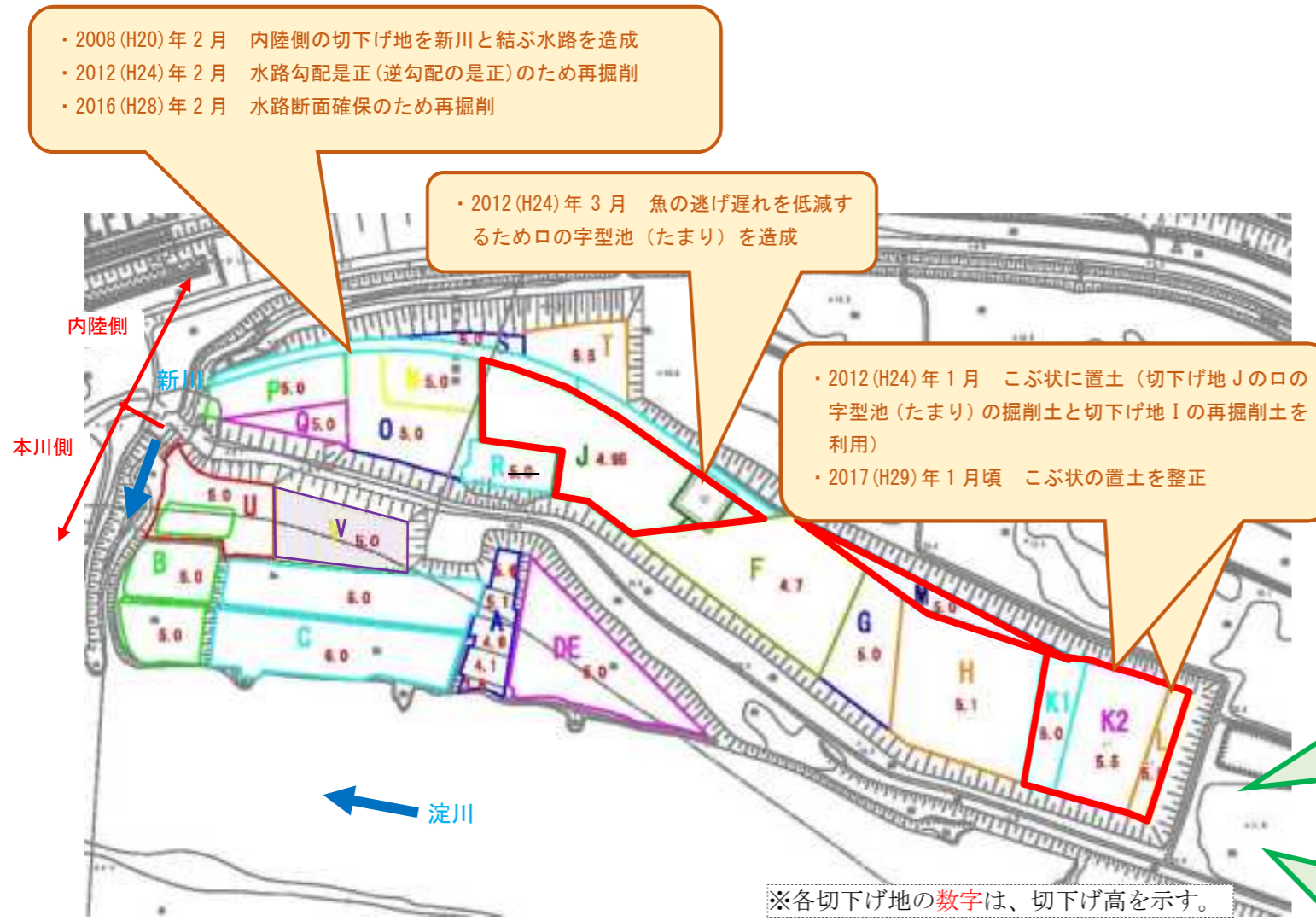
図 2.2 切下げ地位置・切下げ地整備高さ・切下げ地整備後の維持管理 : R1 評価対象
