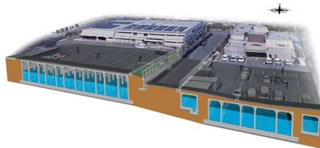
平成緊急内水対策事業 (田原本町阪手南地区・社会福祉協議会駐車場等)
