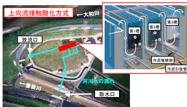
図 1.21 曾我川浄化施設
