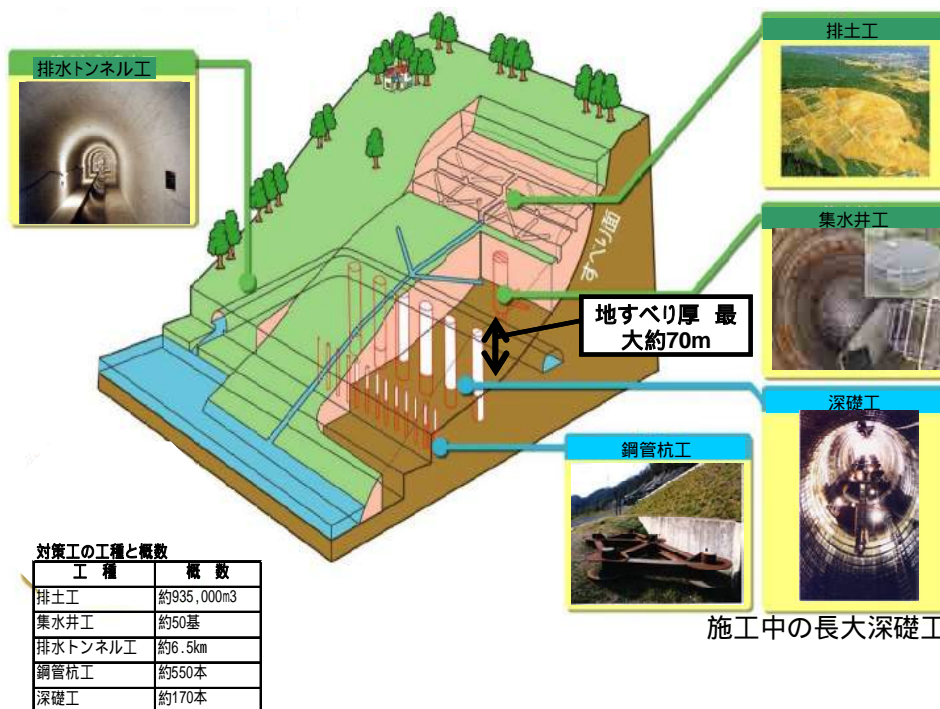
図 1.18 亀の瀬地すべり対策工模式図
