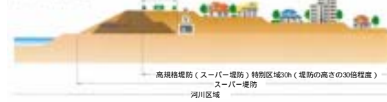
スーパー堤防横断面図(イメージ図)
