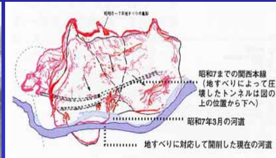
昭和6～7年に亀の瀬峠地区でおこった地すべりによる亀裂
