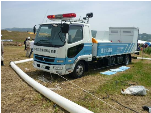
排水ポンプ車による排水
