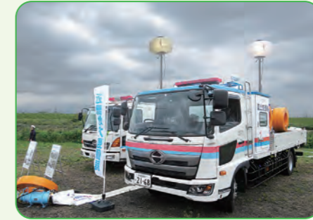
排水ポンプ車 (近畿地方整備局)
