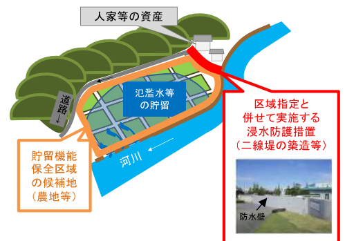
区域指定と併せて実施する二線堤の築造 ※ 等のイメージ
