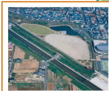
遊水地 河川の流水を遊水地内に越流させることにより、下流の氾濫を軽減します。
