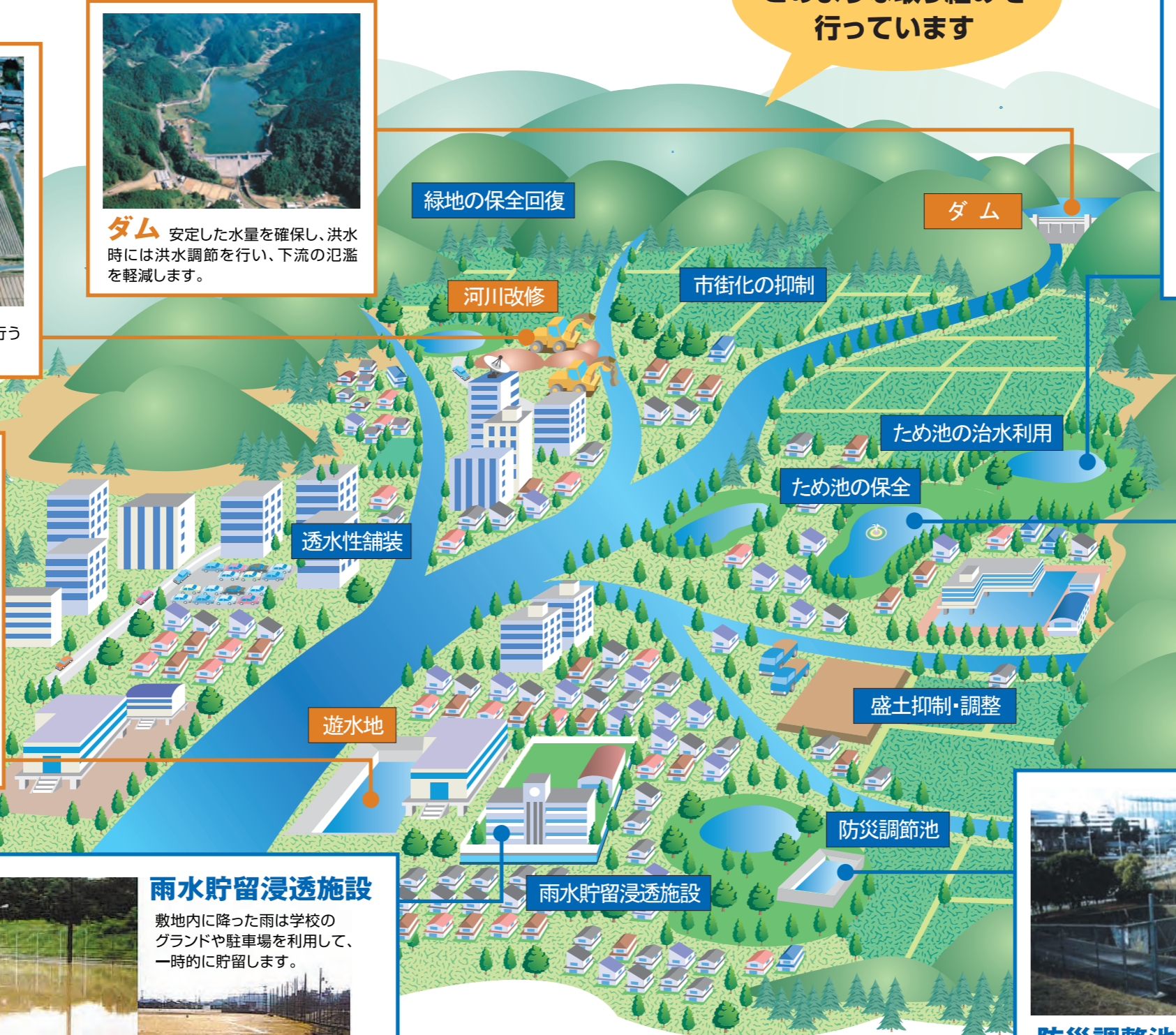
防災調整池 宅地造成等の市街地開発では河川への流出量が増大するため、防災調整池によって雨水を一時的に貯留し、流出を抑制します。
