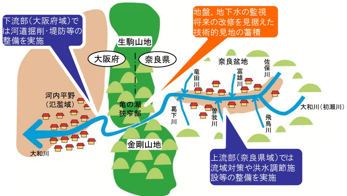
将来、下流部の河道整備が進捗し、所定の治水安全度が確保された後、亀の瀬狭窄部での対策にあたっては、追加的に地すべり対策やバイパストネル\*等の人工的な施設が必要となります。そのため、整備計画期間では、今後得られる地盤や地下水位に関する監視結果や、解析や施工に関する新たな技術的な知見の蓄積を行います。
