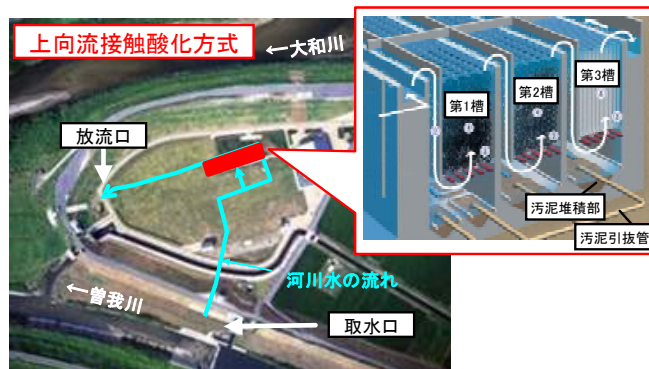
図 1.21 曾我川浄化施設
