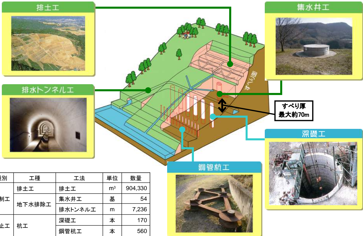
図 1.18 亀の瀬地すべり対策工模式図
