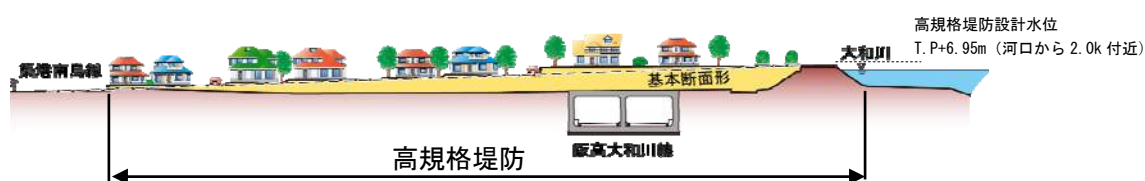
図 4.18 高規格堤防イメージ図
