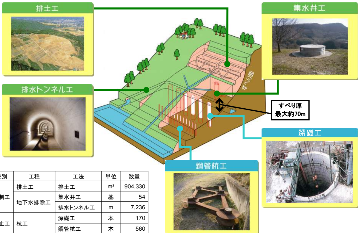
図 1.18 亀の瀬地すべり対策工模式図
