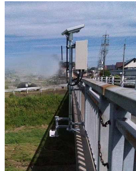
危機管理型水位計(超音波式) (設置例)
