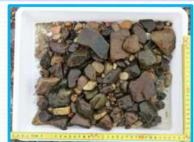
河床材料調査 大和川 河川管理レポート 2014
