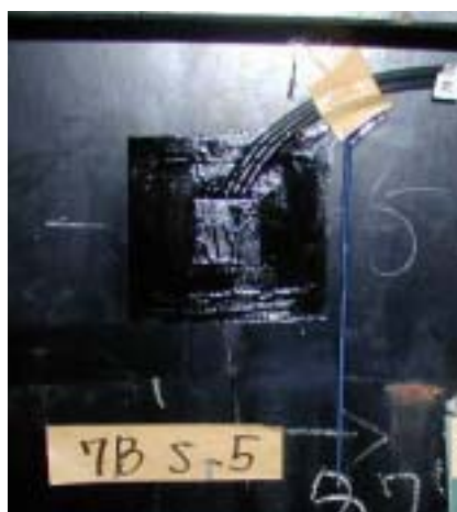
写真 3.4 ひずみゲージ(養生後)
