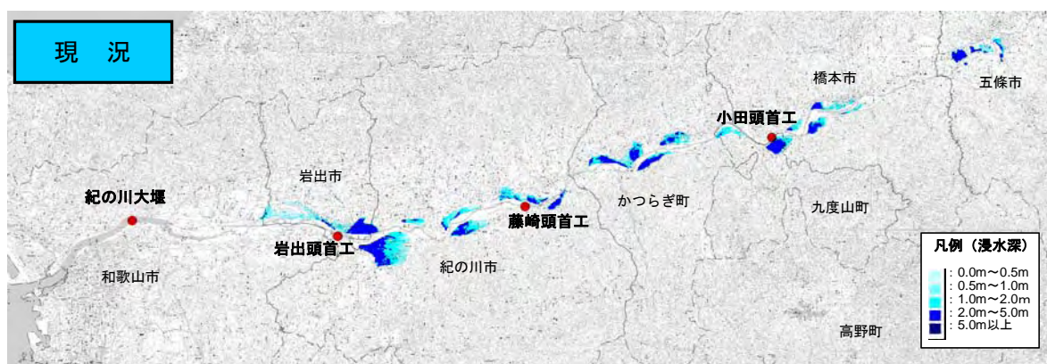
図 2.1.2 現在の河道状況で想定されるはん濫状況 【戦後最大洪水(昭和34年9月)：大滝ダム供用】
