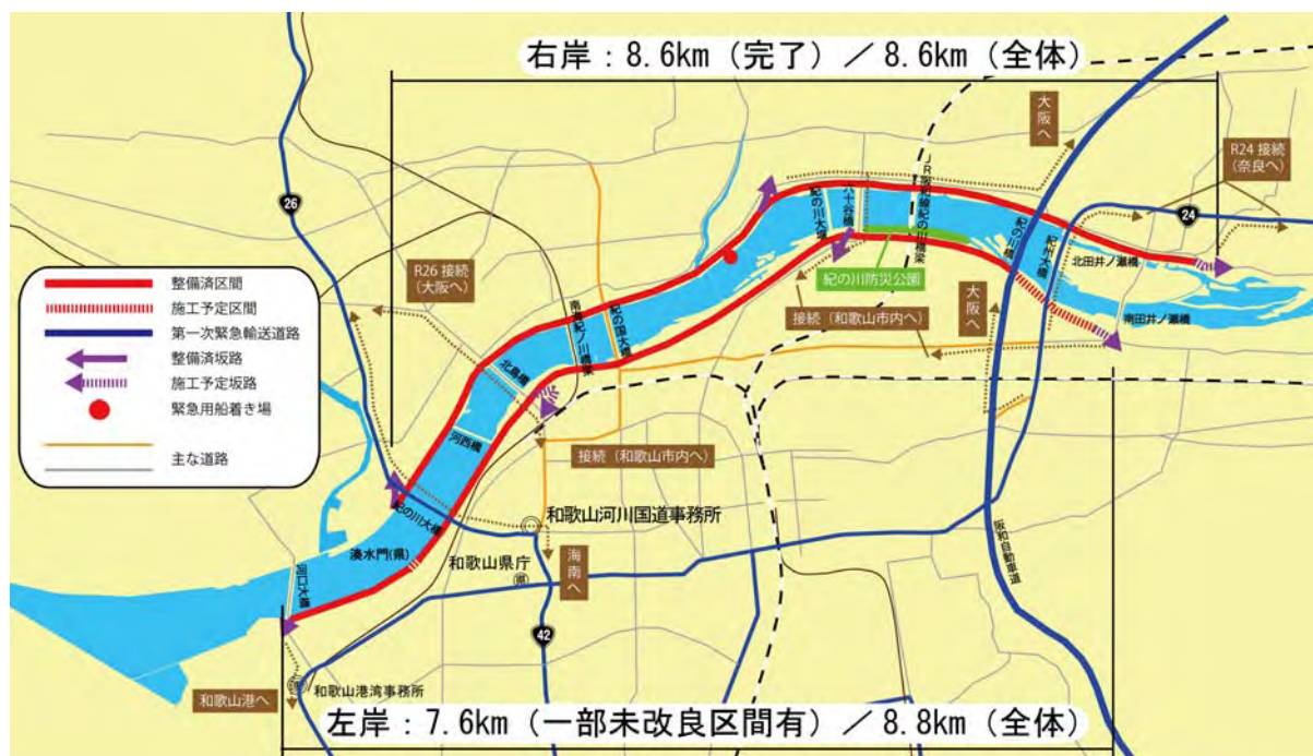
図 4.1.6 緊急用河川敷道路施工予定図
