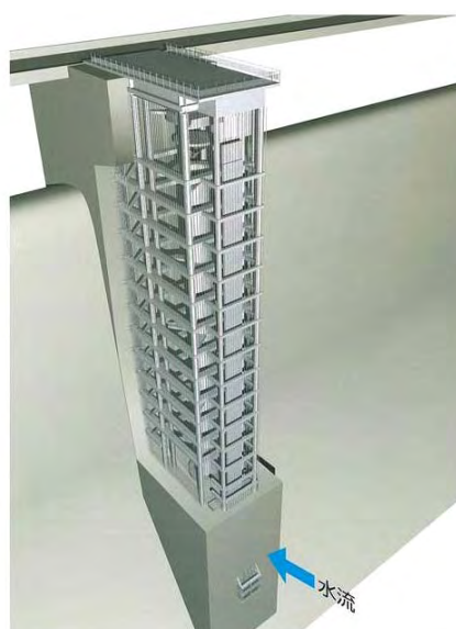
図 2.4.7 大滝ダム-選択取水設備
