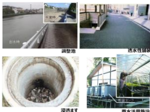
雨水貯留浸透施設の例
