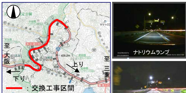
工事区間: 87.6kp~91.5kp 工事期間: 上り2010.8, 下り2010.8~9 交換箇所: 上り49箇所, 下り82箇所
