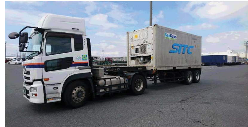
20ft 2軸トレーラ 最大積載20.32t(コンテナ自重込) 連結車両総重量 最大33.5t
