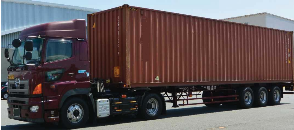
40ft 背高3軸トレーラ 最大積載30.48t(コンテナ自重込) 連結車両総重量 最大44t
