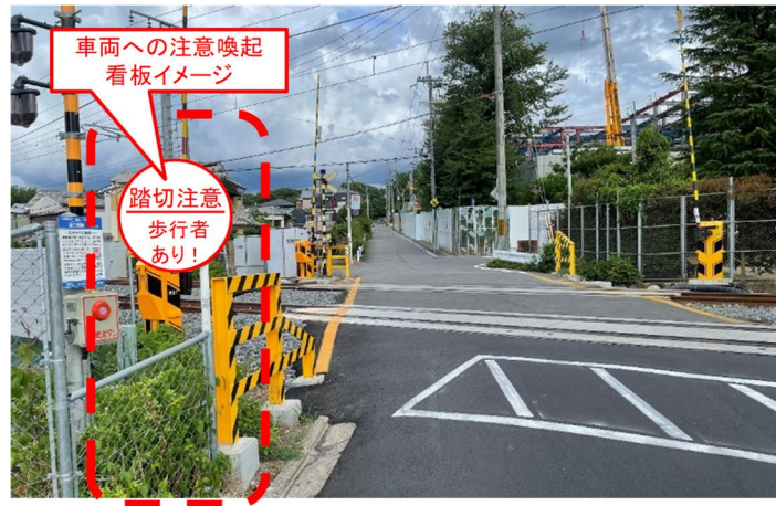
写真 2-7-● 車両への注意喚起看板等の設置例
