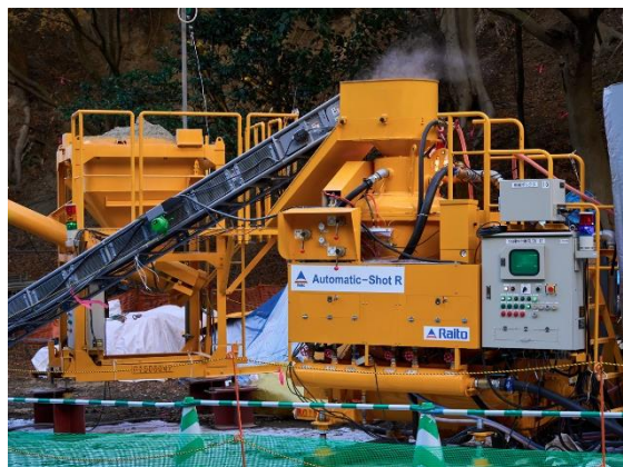
■ 写真-3 全自動吹付プラント (Automatic-Shot R)
