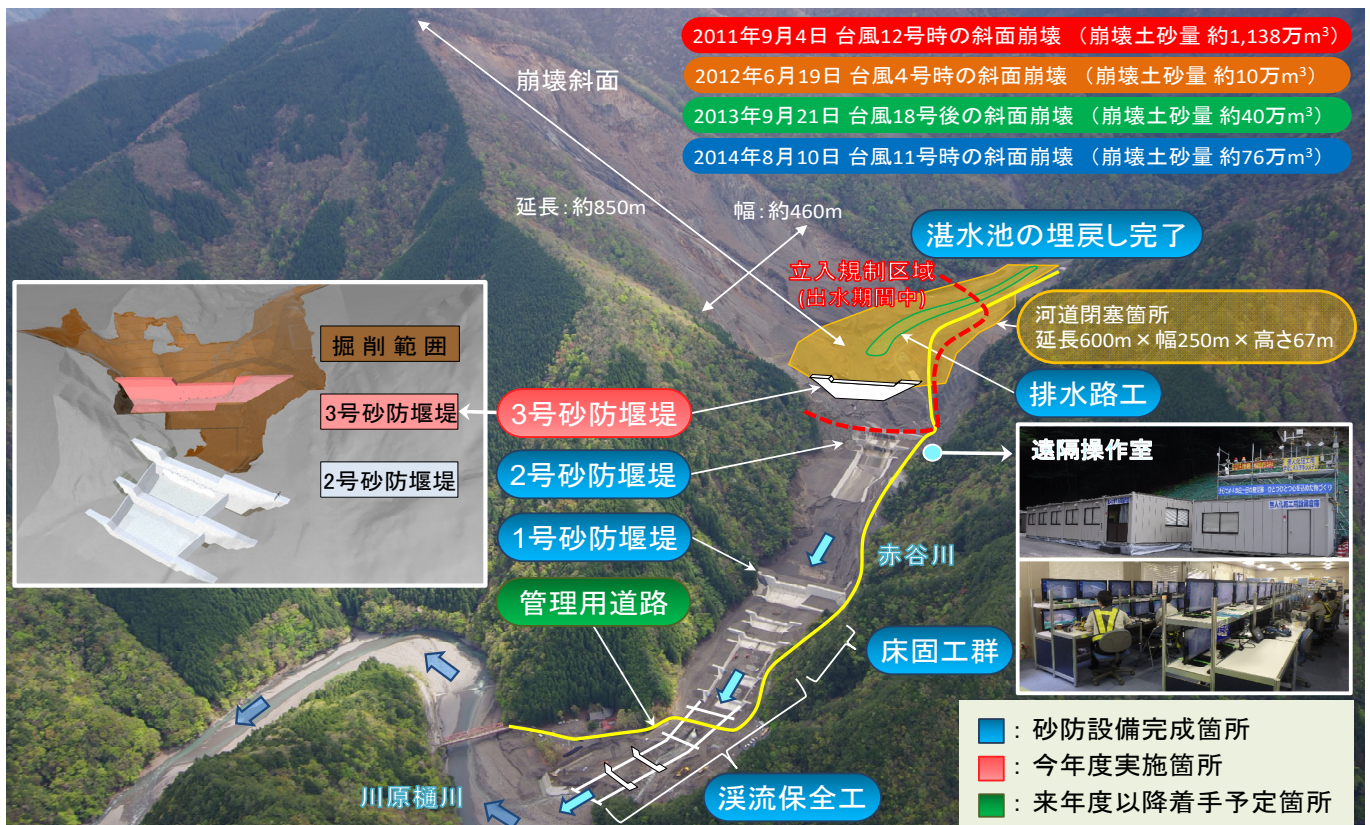
図-2 赤谷地区対策工事全体概要図
