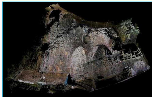
・ 伐採・法面清掃後点群データ
