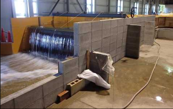
転倒式ゲートによる下流端水位の調節
