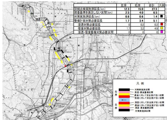
図 4.3.2-8 桂川 堤防詳細点検及び対策位置図
