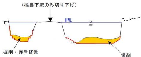
図 4.3.2-20 塔の島地区掘削断面図
