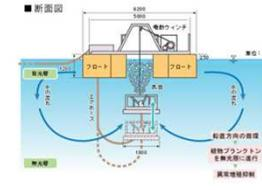
図 4.2.5-1 循環曝気設備の概念図
