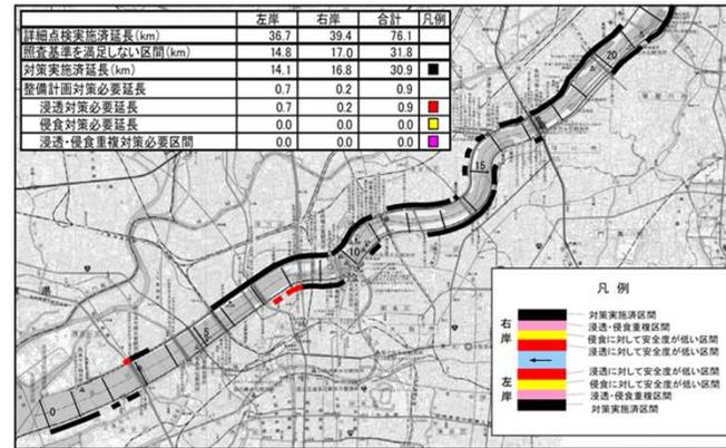
図 4.3.2-5 淀川 堤防詳細点検及び対策位置図(1/2)
