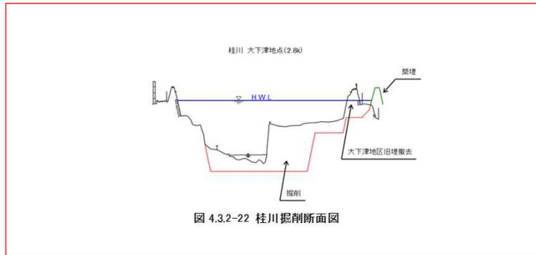
図 4.3.2-22 桂川掘削断面図
