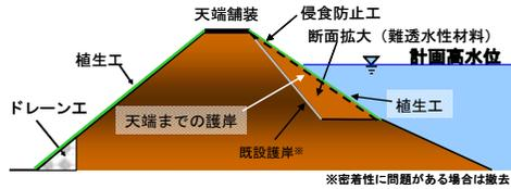
図 4.3.2-4 堤防強化対策工法の例
