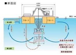
図 4.2.5-1 循環曝気設備の概念図
