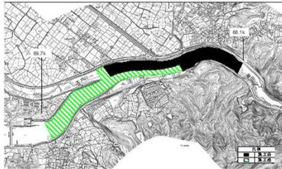
図 4.3.2-25 瀬田川河床掘削平面図
