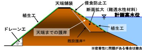
図 4.3.2-4 堤防強化対策工法の例
