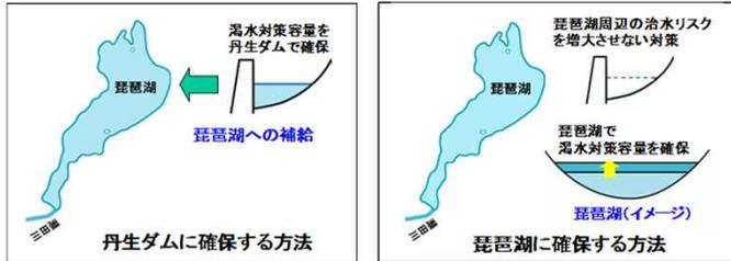
図4.4.3-1 渇水対策容量の確保方策イメージ
