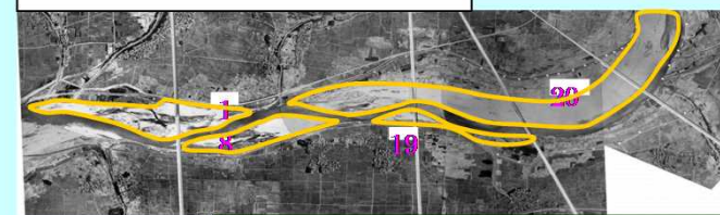
S23年(1948年) 18.5-23K 滯筋は単列蛇行。砂州に植生はみられない。
