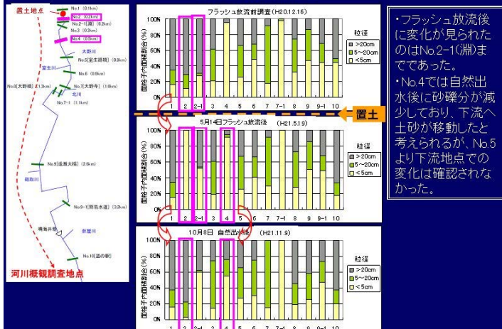
室生ダム下流における河床材料の変化 [河川概観調査]
