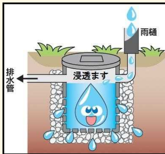
雨水浸透ます（屋根に降った雨を地下に浸透させる小さな穴の開いたます）
