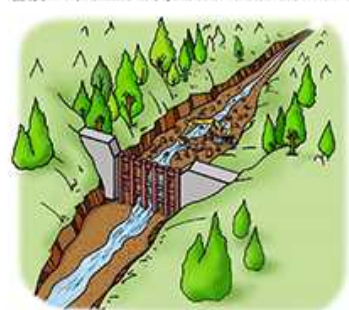
④ 堰堤にたまった岩、土砂や流木は、次の土石流に備えて取り除きます。
