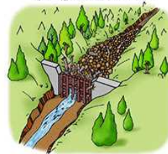
③ 大雨が降り土石流が発生したとき、大きな岩、流木などを含む土砂は、堰堤に引っかかり止まります。
