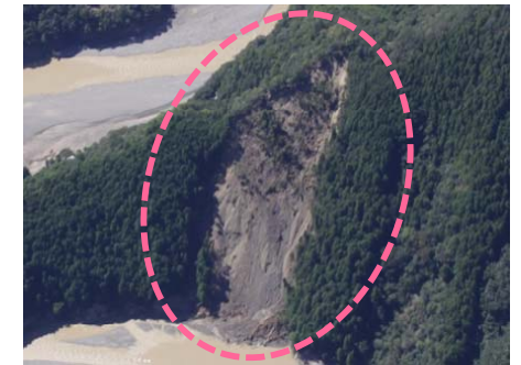
⑩折立地区(被災直後) ・崩壊規模 2.36ha ・対策: 山腹工
