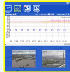
【ハイドログラフ】 川の水位の時間的な変化をグラフで表示
