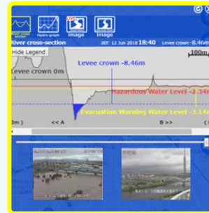
【河川横断面図】 川の水位とまち側の地盤の高低差を断面図で表示
