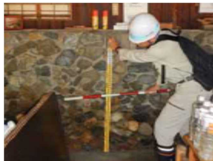
写真 1.1.3-6 渡月橋付近の越水箇所（7 月 9 日痕跡調査）
