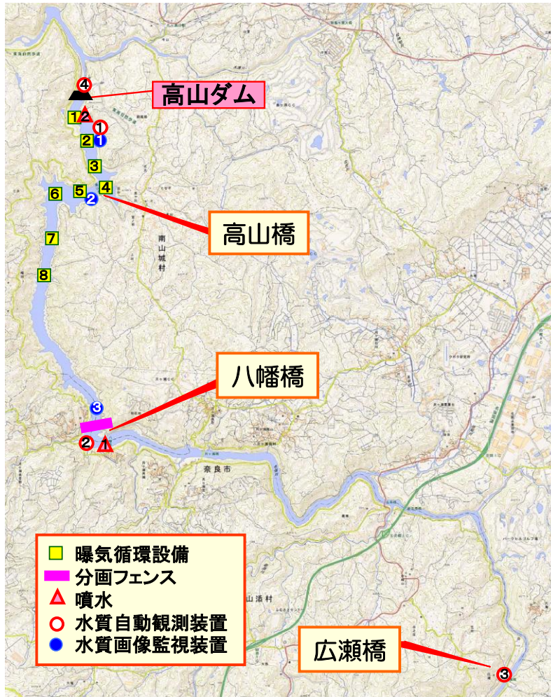
図 5. 6. 1-1 水質保全施設の設置位置
