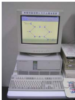
画像切替制御装置
