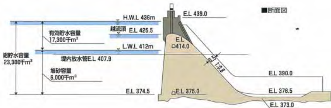
図 3.1.1-1 猿谷ダム貯水池容量配分図
