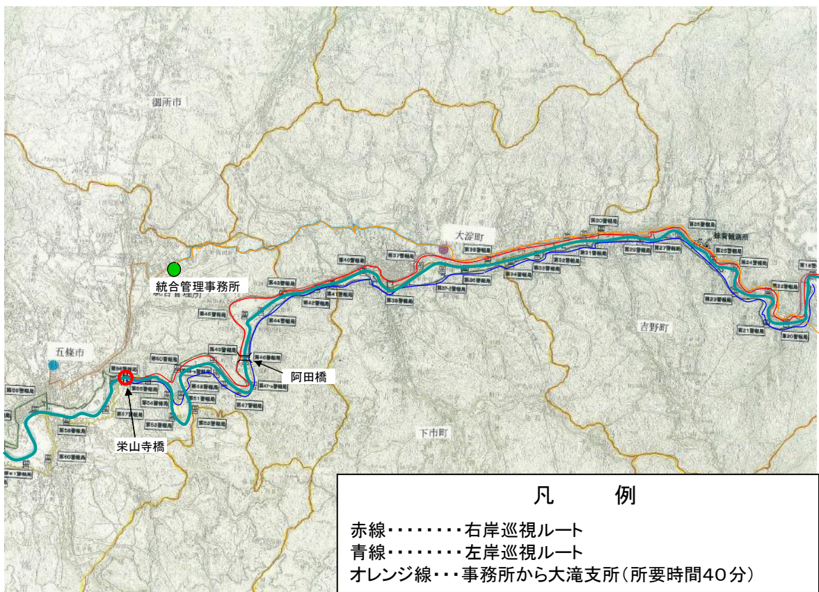
図 1.4.1-6 大滝ダム巡視経路 (大滝ダム放流量 400m 3 /s 未満) (出典:大滝ダム年次報告書)
