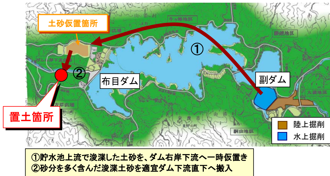
図 6.5.1-1 土砂還元の実施方法
