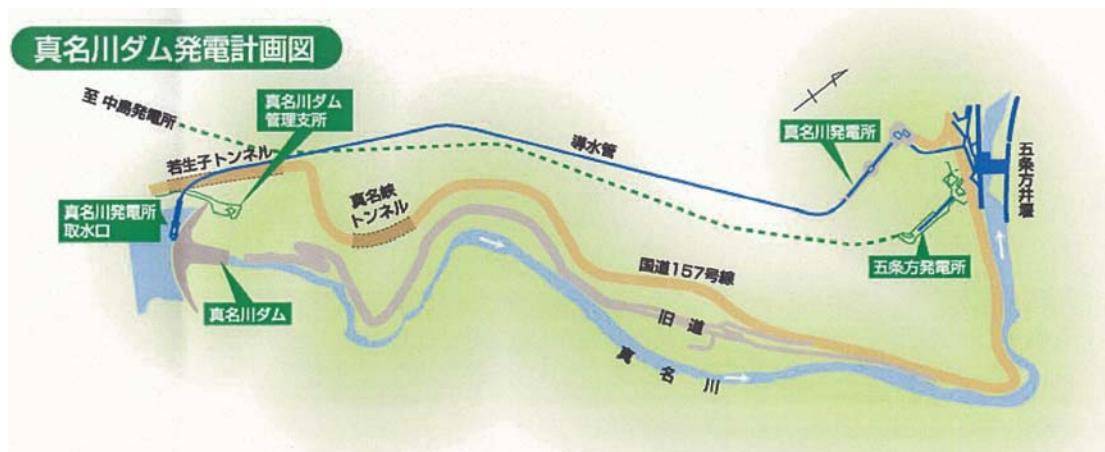
図 3.3-1 真名川ダム発電計画図（無水区間）
