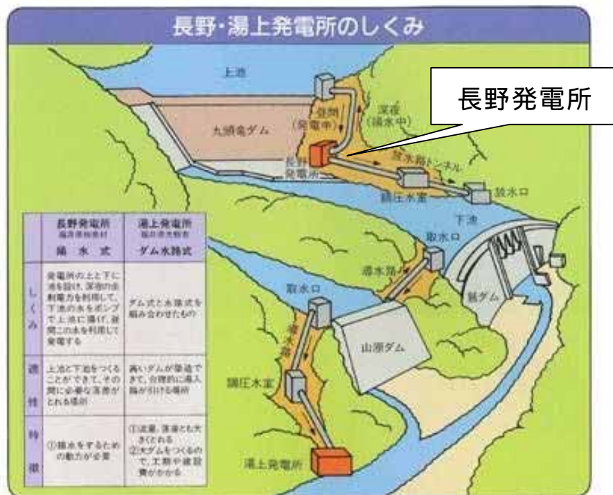
図 3.2 - 3 長野・湯上発電所のしくみ
