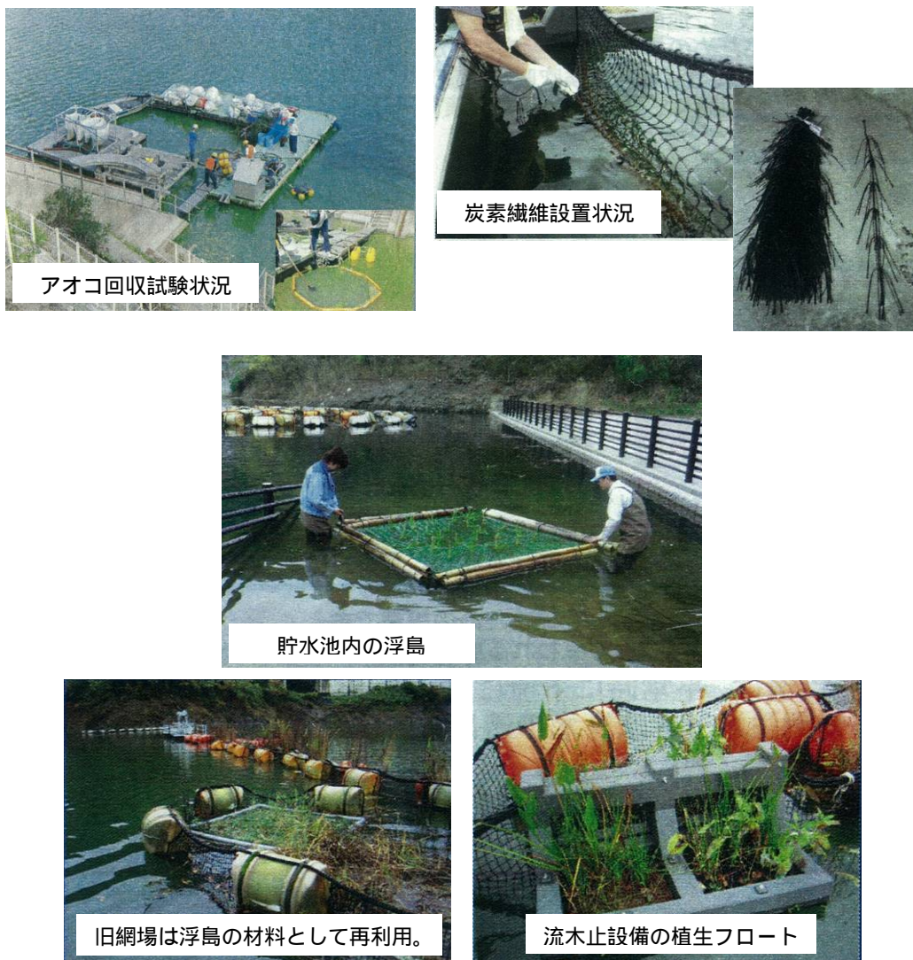
図 5.7.4-1 一庫ダム水質浄化実験状況
