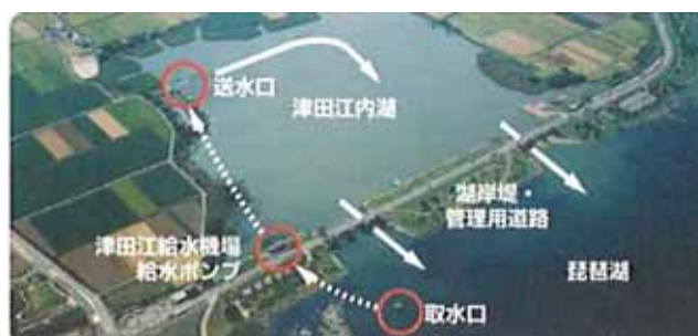
写真 1.3-2 津田江内湖の水位保持施設
